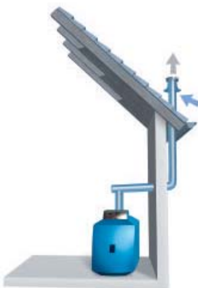
Primer namestitve z zajemom zraka izven prostora, z uporabo koaksialnega dimnovodnega sistema po zunanji strani fasade
